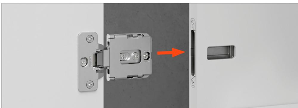
Una volta inserita completamente, bloccare la cerniera tramite l'eccentrico posteriore
